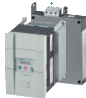
Convertisseur de fréquence DF5 avec filtre monté à l'arrière
